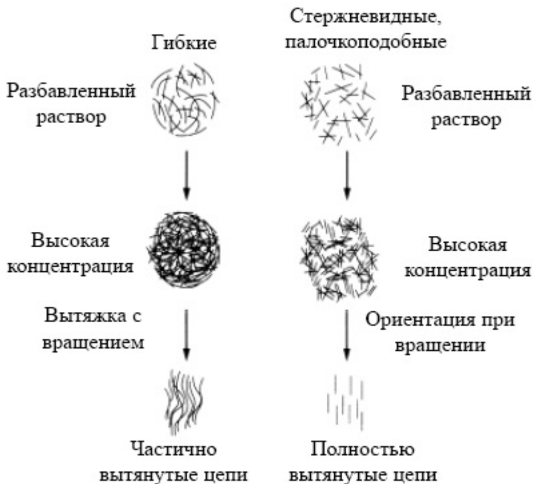
Рис. 1. Различие в поведении во время формирования волокна между гибко- и жесткоцепными полимерами
