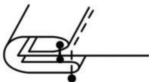
Окантовочный шов с закрытым срезом
