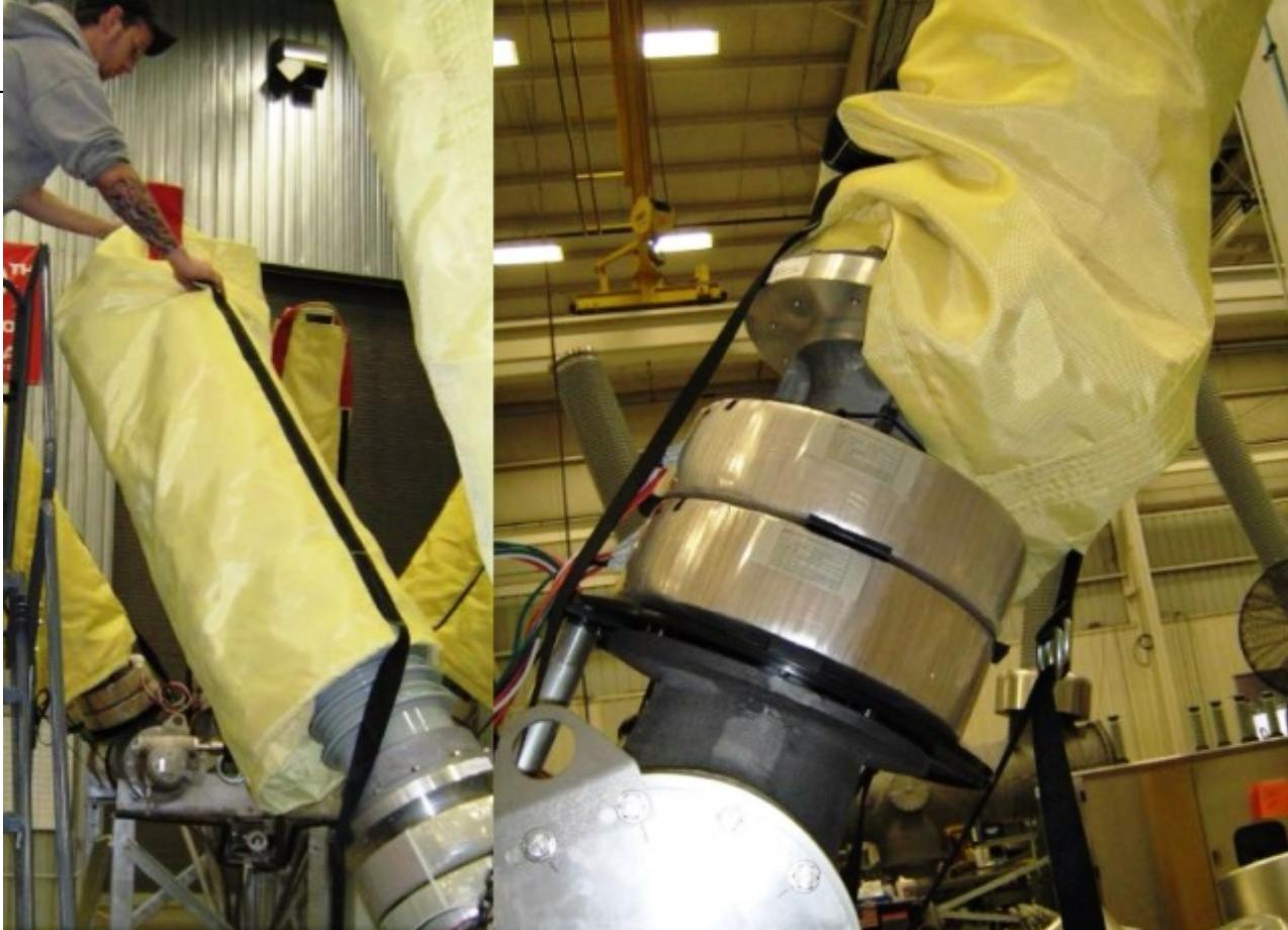
Взрывозащитный противоосколочный защитный чехол изготавливается в виде многослойного изделия цилиндрической формы с утягивающими ремнями, ремнями стяжки и крепления, а также, монтажными ремнями для установки краном.
