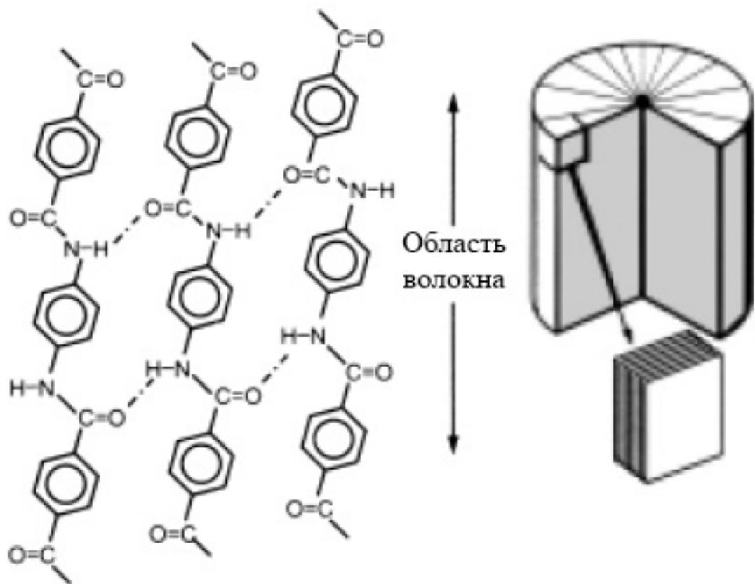
Рис. 2. Цилиндрическая структура волокна, радиально сложенного из плоскостей, связанных водородными связями
